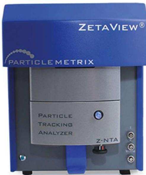
当センターでは、令和元年度補正ものづくり補助事業で、粒子測定装置を整備しました。この装置は、液中粒子からの散乱光を画像で捉え、その粒子数をカウントし、個数濃度（個数/mL）を計算します。液中粒子は、ウルトラファインバブルの様な1um以下の粒子も測定できます。また、顕微鏡電気泳動法により、粒子と液体の界面に形成される電気二重層の間に発生する電位を測定する機能も備えています。
