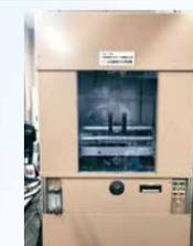
回転磁場中熱処理炉
