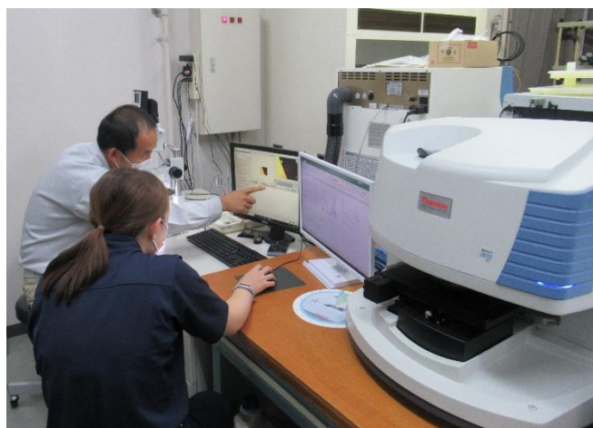
顕微フーリエ変換赤外分光光度計(FT-IR)分析の様子
