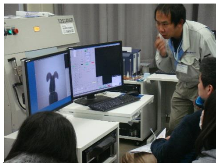
X線CTによる欠陥分析
